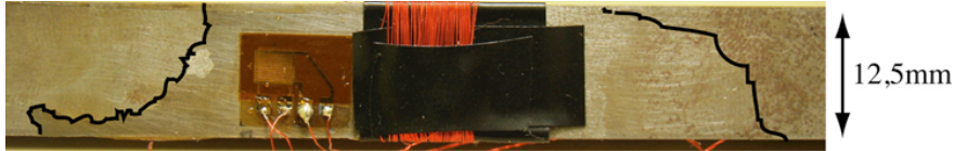
FIGURE 1 : Détail d'une éprouvette : visualisation du cristal, du bobinage et des jauges.
