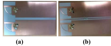
Figure 7 : Prototypes des réseaux classiques alimentés à deux ports. (a) antenne de référence et (b) antenne découplée.
