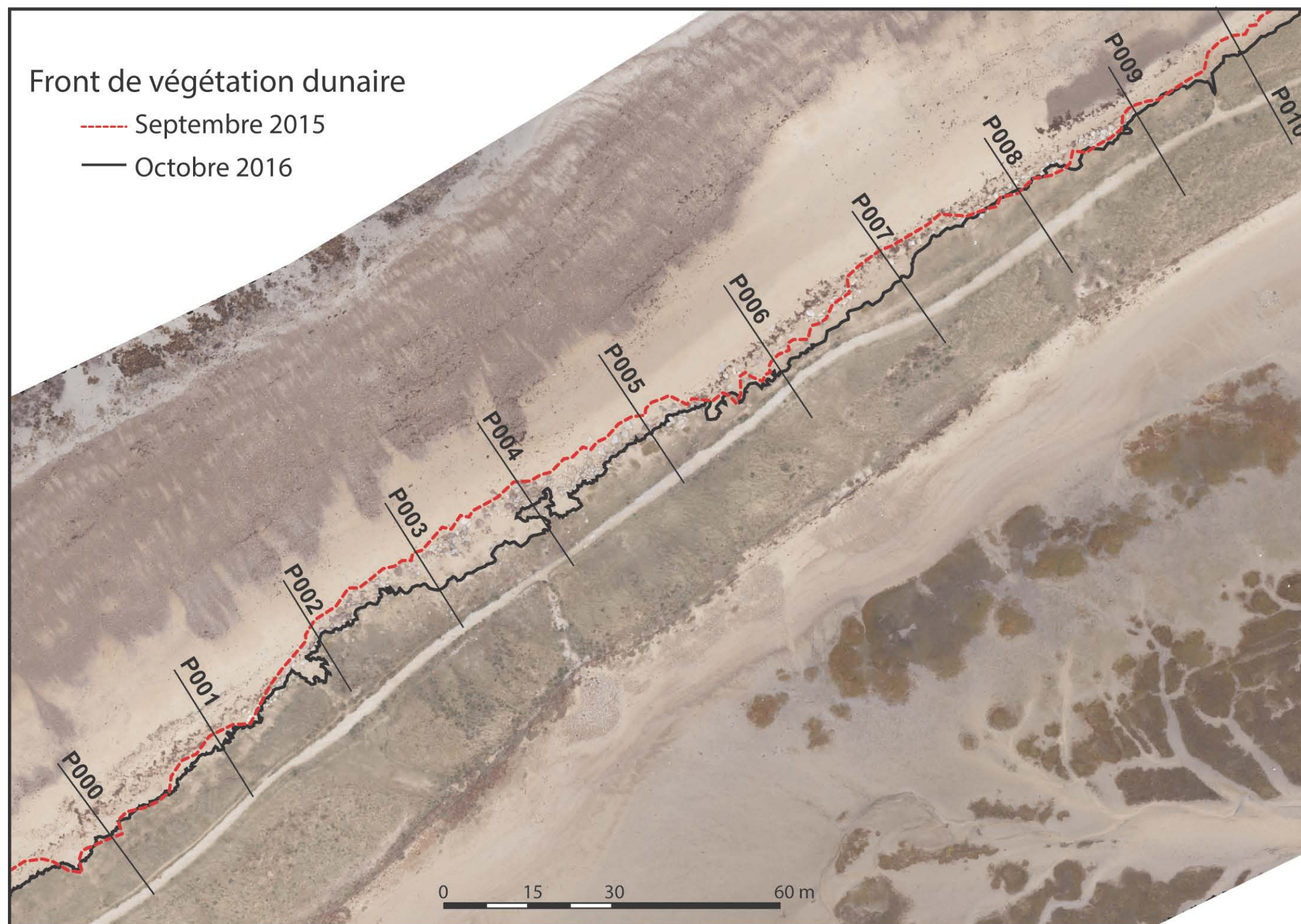
Figure 13 : Erosion du front de la dune du Chouck en 2016
