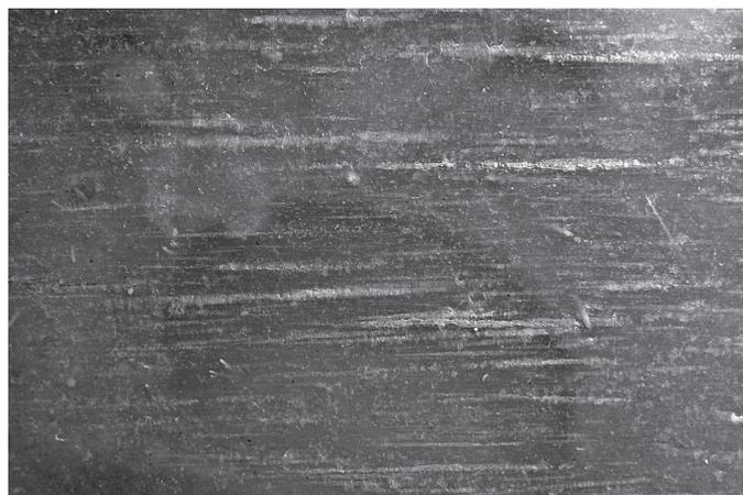
**Fig. 48** – Aspect d'une facette déterminée par un polissage doux expérimental (pression de quelques kg).
