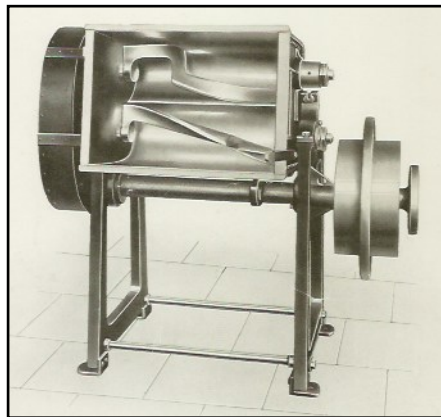
Mélangeur en Z Frogerais (Ivry-sur-Seine, F, 1920)
