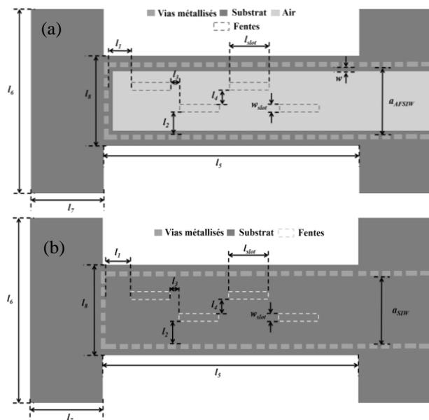
**Figure 2. Structure de l'antenne à fentes en (a) SIW creux ( $a_{AFSIW}=7,04$ ,  $w=0,508$ ,  $w_{slot}=0,54$ ,  $l_{slot}=4,91$ ,  $l_1=2,52$ ,  $l_2=2,73$ ,  $l_3=1,03$ ,  $l_4=0,51$ ,  $l_5=31,58$ ,  $l_6=17$ ,  $l_7=12,1$ ,  $l_8=6,61$  en mm) et (b) SIW ( $a_{SIW}=4,11$ ,  $w_{slot}=0,7$ ,  $l_{slot}=3,2$ ,  $l_1=0,42$ ,  $l_2=1,3$ ,  $l_3=0,16$ ,  $l_4=0,16$ ,  $l_5=20,383$ ,  $l_6=17$ ,  $l_7=12,1$ ,  $l_8=10,8$  en mm).**
