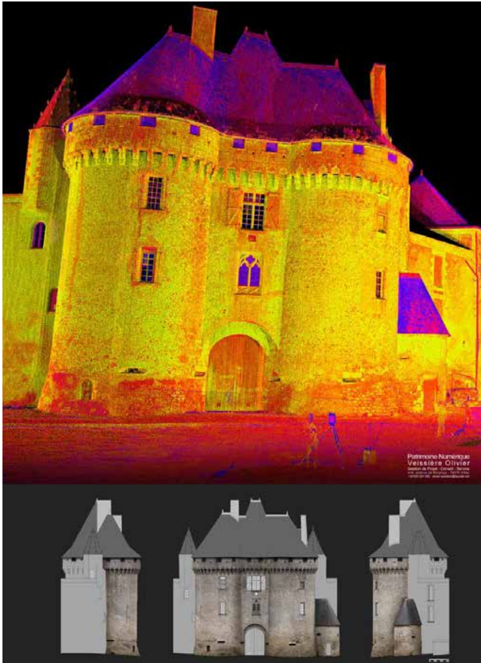
Fig. 10. Exemple de relevés lasergrammétrique et photogrammétrique (château de Barbezieux – 16) (Source : O. Veissière).
