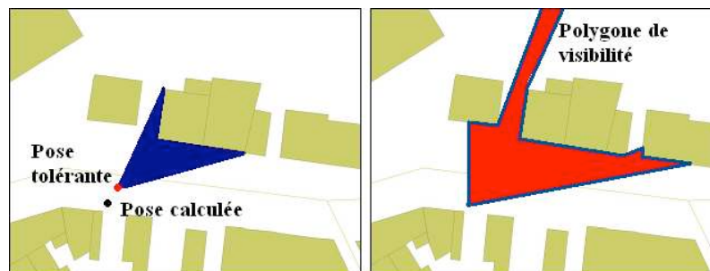
Figure 6 – Illustration de la requête de non-obstruction (à gauche) et du calcul des polygones de visibilité (à droite). Il s'agit dans les deux cas de déterminer un polygone n'ayant pas d'intersection avec les polygones du SIG
