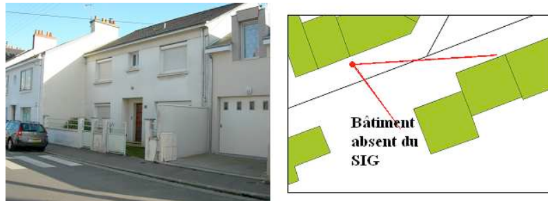
Figure 7 – Situation dans laquelle le SIG n'est pas à jour. Le SIG (à droite) ne correspond plus à la photographie (à gauche) en raison d'un bâtiment qui a été construit récemment.
