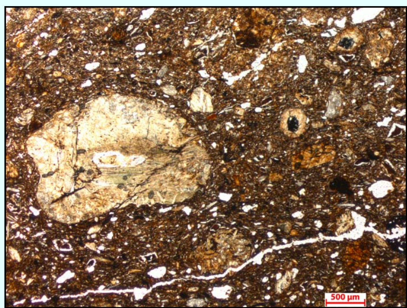
Micrographie d'une céramique proto-onctueuse de l'île aux Moutons (29) en lumière naturelle. La matrice brune est de l'argile, le gros grain blanchâtre est du talc, et les grains oeilés sont de la serpentine.
