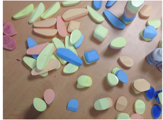
Figure 1. Les pierres musicales. Un moule en silicone a été réalisé à partir de prototypes sculptés dans du bois. La résine permet d'ajouter facilement des colorants, dans la masse, pour obtenir des couleurs variées et stables.
