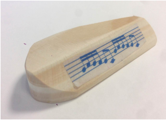
Figure 1. Les pierres musicales. Un moule en silicone a été réalisé à partir de prototypes sculptés dans du bois. La résine permet d'ajouter facilement des colorants, dans la masse, pour obtenir des couleurs variées et stables.
