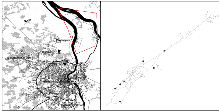
Figure 1: Réseau de distribution de la commune d'Ambès, à gauche encadré en rouge, à droite sous la forme d'un réseau de graphe (les points noirs représentant les points de mesures de débit)
