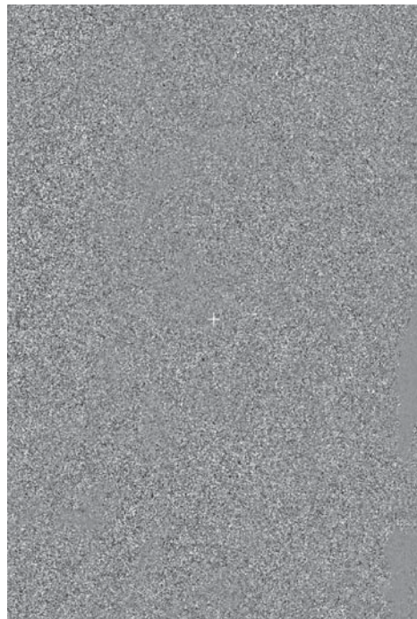
Abb. 4: Ungefilterte 32-bit SAR-Radarszene des ERS-1 Sensors aus dem Jahre 2002 von Jordanien. Ohne die Anwendung von Filterungs- und Entzerrungsverfahren ist zunächst nur Rauschen zu erkennen.
