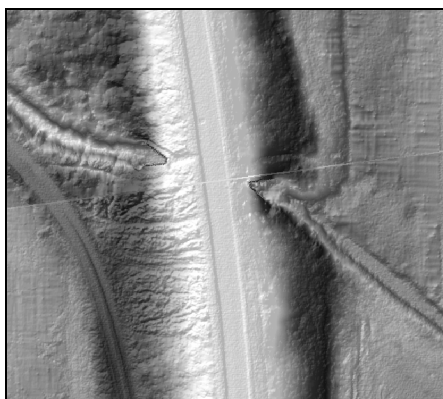
FIGURE 5. EXEMPLE DE VISUALISATION SUR LE MNT D'UNE GALERIE BATARDABLE TRAVERSANT LA DIGUE
