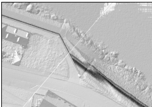
FIGURE 8. ZONE DE TRANSITION ENTRE UN REMBLAI EN TERRE ET UN QUAI MAÇONNE VISIBLE SUR LE MNS AVEC OMBRAGE
