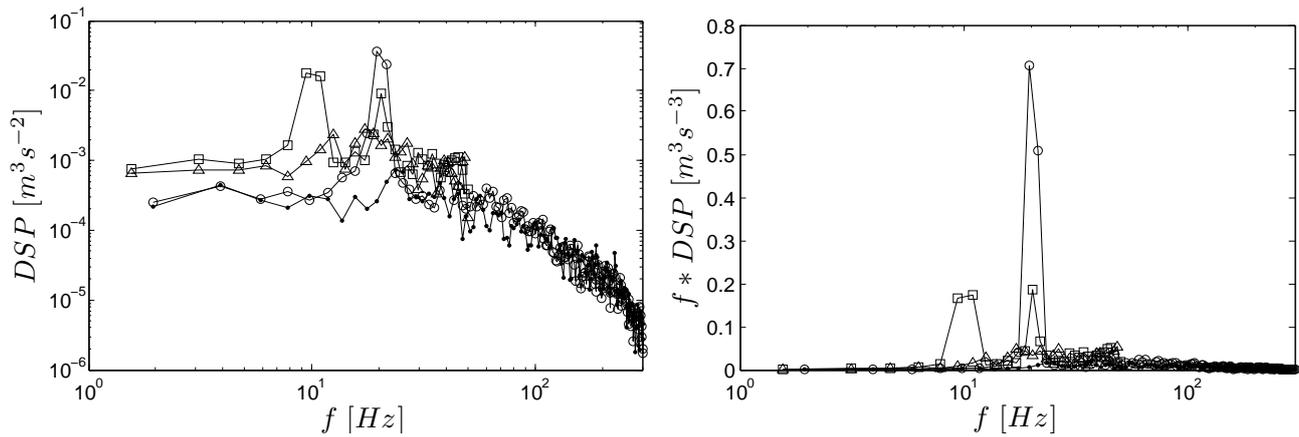
FIGURE 5 – Densité spectrale de puissance à gauche et spectre pré-multiplié à droite de la vitesse verticale dans le plan 5, au point  $x = 600 \text{ mm}$  et  $y = 0 \text{ mm}$  :  $\bullet$ , cas naturel ;  $\square$ ,  $f_{pulse} = 10 \text{ Hz}$  ;  $\circ$ ,  $f_{pulse} = 20 \text{ Hz}$  ;  $\triangle$ , mode continu.
