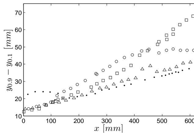
FIGURE 4 – Évolution longitudinale de l'épaisseur de la couche de mélange  $\delta_u$  :  $\bullet$ , cas naturel ;  $\square$ ,  $f_{pulse} = 10 Hz$  ;  $\circ$ ,  $f_{pulse} = 20 Hz$  ;  $\triangle$ , mode continu.
