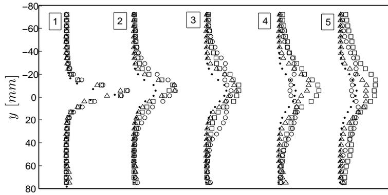
FIGURE 3 – Profils de la tension de Reynolds  $\langle u'u' \rangle$  :  $\bullet$ , cas naturel ;  $\square$ ,  $f_{pulse} = 10 Hz$  ;  $\circ$ ,  $f_{pulse} = 20 Hz$  ;  $\triangle$ , mode continu.
