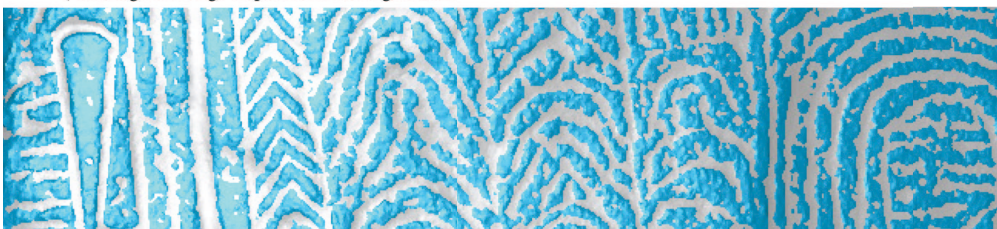
↑ Superposition d'un maillage lissé (gris) et d'un maillage haute définition (bleu). Le maillage lissé s'intercale dans l'épaisseur des gravures du maillage haute définition.
