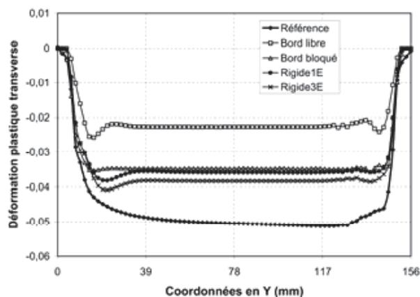
**Figure 4.** Comparaison des déformations plastiques transverses ( $x=0mm$ )
