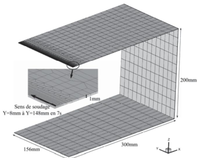
Figure 1. *Modèle de référence en éléments finis*
