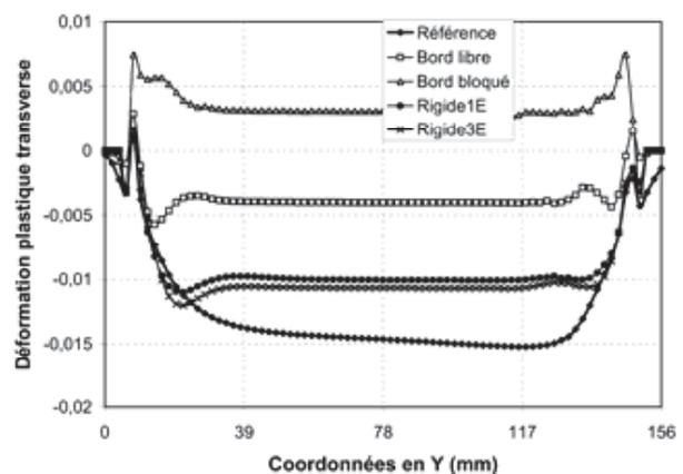
**Figure 5.** Comparaison des déformations plastiques transverses ( $x=1,6mm$ )
