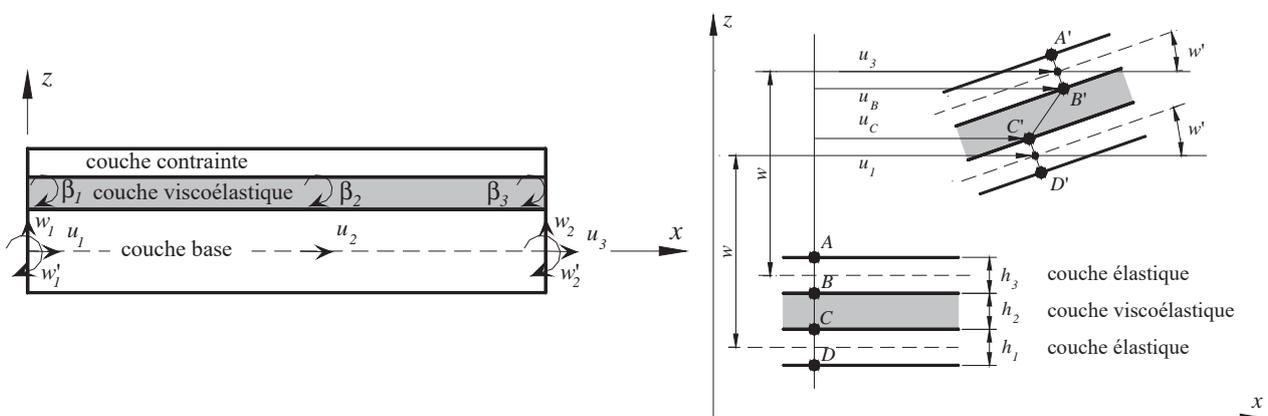
**Figure 1.** *Elément fini trois couches de poutre*
