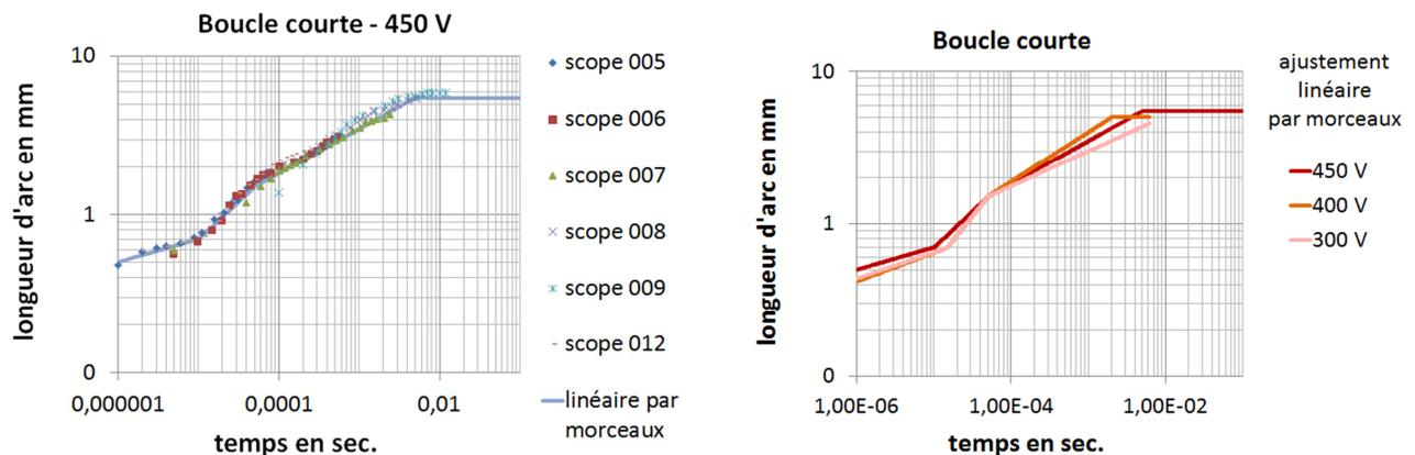
Figure 4 : allongement d'arc mesuré pour différents essais d'échantillons identiques. A gauche reproductibilité de l'essai à 450V et pour différentes cadences d'imagerie. A droite effet de la tension de charge du condensateur, ajustements linéaires par morceaux pour chaque niveau de tension d'essai.
