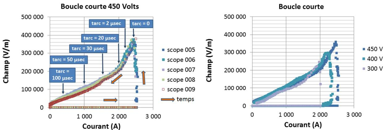
Figure 5 : champ électrique pour des échantillons identiques. A gauche, reproductibilité de l'essai à 450 V et boucle courte. A droite effet de la tension de charge du condensateur.
