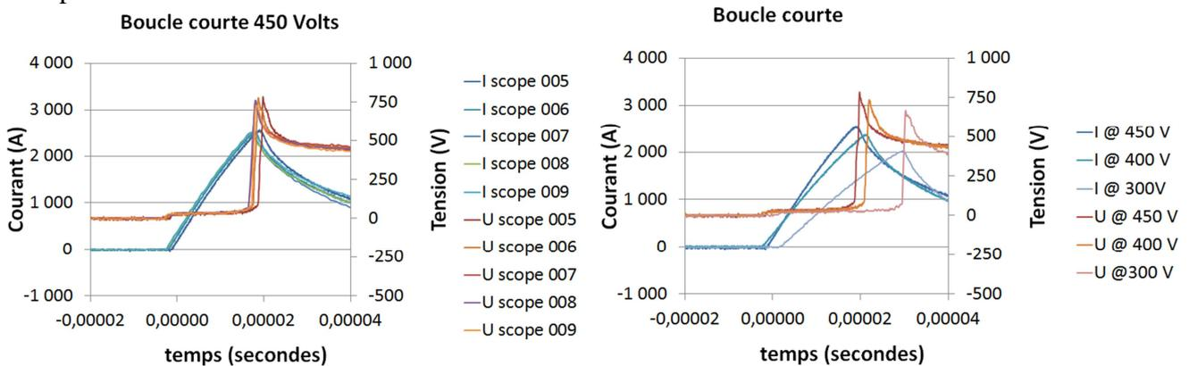
Figure 3 : Traces de courant et tension pour des échantillons identiques. A gauche, reproductibilité de l'essai à 450 V et boucle courte. A droite, effet de la tension de charge du condensateur.
