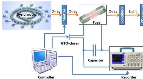
Figure 1 : schéma simplifié du dispositif d'essais, avec ses principaux composants
