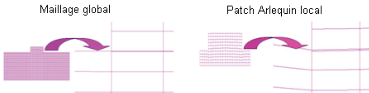
Figure 4. Premier calcul sur le maillage initial pour les premiers cycles de frettage et 2 ème calcul sur les patchs Arlequin après actualisation de géométrie
