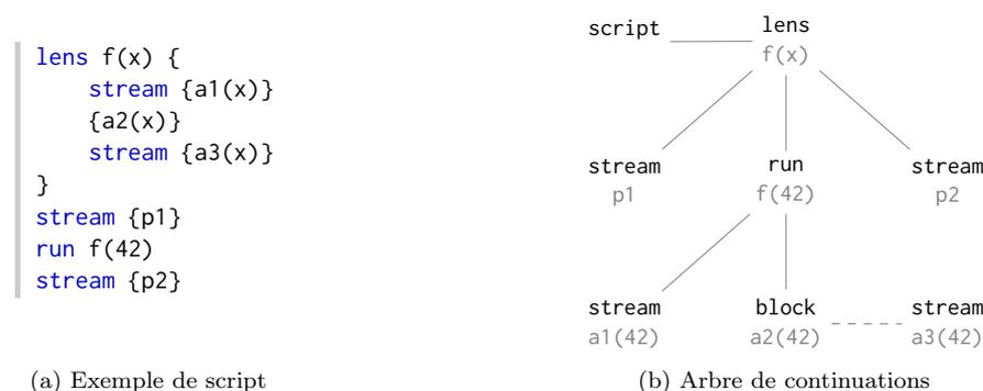
FIGURE 5 – Exemple de script et l’arbre de continuations associé. L’exécution de la racine du script peuple toutes les sections jusqu’au bloc `a2(42)` (lignes continues). Puis l’exécution du bloc permet de peupler la dernière section `stream` (ligne pointillée).
