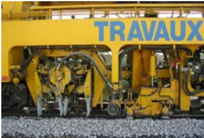
*Illustration 4: Bourreuse mécanique - Photo ETF*
