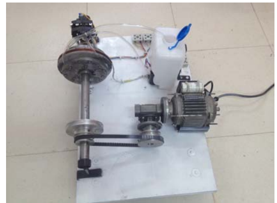
Figure 5. Prototype de la machine supraconductrice réalisée
