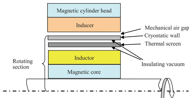
Fig. 4. Section d'une machine synchrone à inducteur supraconducteur.
