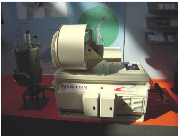
Fig. 5. Moteur construit lors du projet européen ULCOMAP
