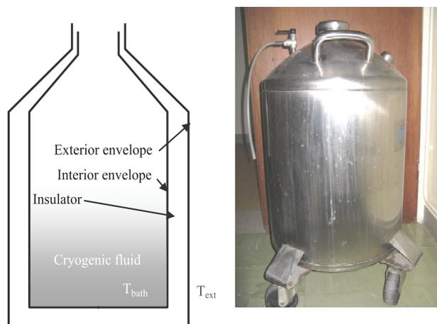
Fig. 3. Cryostat simple
