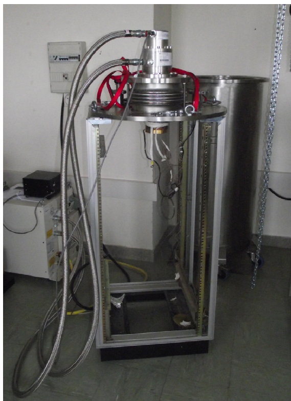
Fig. 7. Cryocooler et cryostat du système de caractérisation d'échantillon MgB_2
