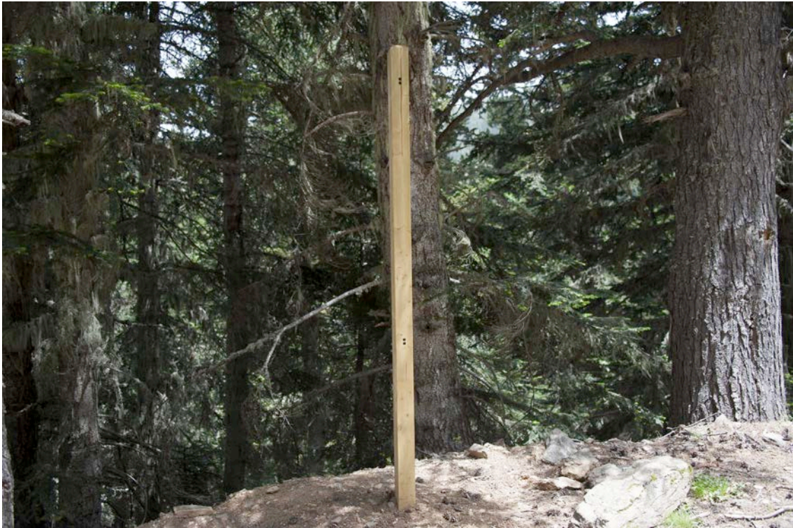
Figure 102 — bis. Ecompteur nouvelle génération pyroélectrique infrarouge à lentille haute précision, en bois, distingue 4 flux différents — cliché Vincent Vlès, 2016 (Canigó)
