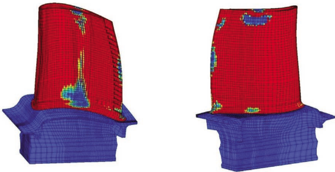
Figure 8. (a) Prévission de durée de vie sur une aube de turbine subissant un chargement thermomécanique.
