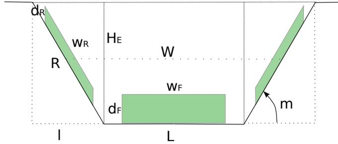
FIGURE 2 – Notations sur un profil de fossé trapézoïdal symétrique avec végétation (vert).  $l$  et  $L$  (largeur en fond de fossé  $L$ ) peuvent être aisément calculés à partir de  $W$  (*Largeur*),  $H_e$  (Profondeur d'eau) et  $m$ , fruit des parois.
