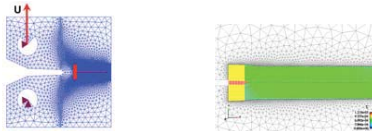
Figure 3. Rupture d'une éprouvette CT25 présentant une zone locale fragile
