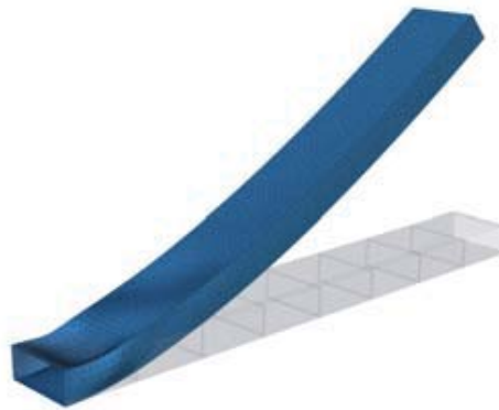
Figure 1. Caisson raidi en flexion (configuration initiale et déformée)
