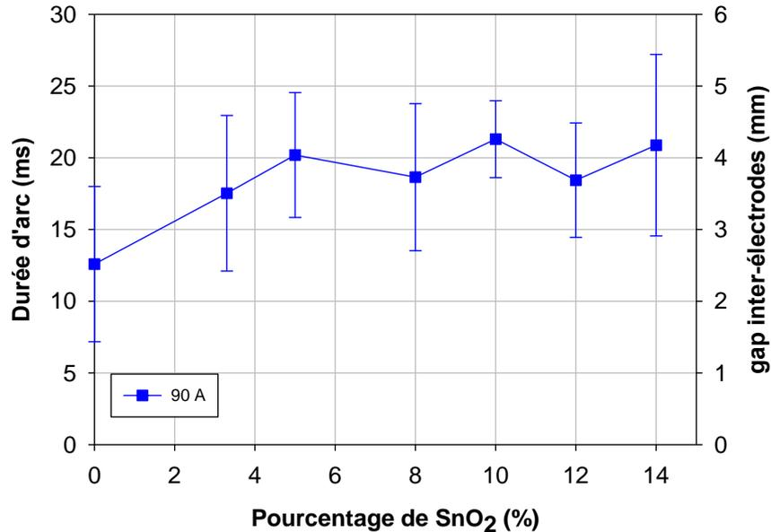
**Figure 5.** Durée d'arc et gap inter-électrodes en fonction du pourcentage de SnO<sub>2</sub> sous 42VDC et pour un courant de 90A.
