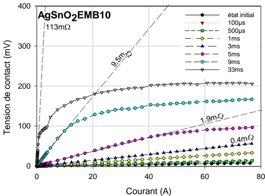
**Figure 9.** Évolution de la tension de contact en fonction du courant pour différentes durées d'arc sous 42VDC et 90A pour des électrodes en AgSnO<sub>2</sub>EMB10.
