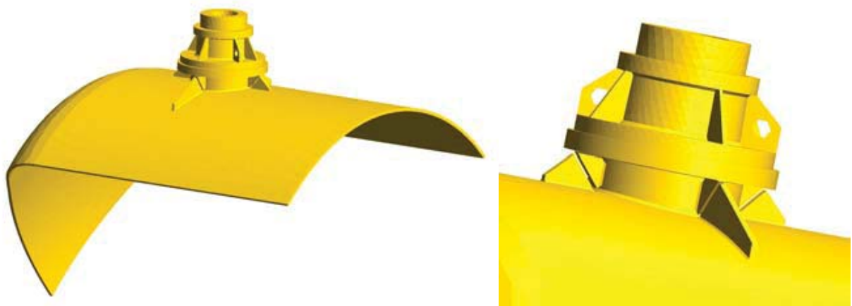
Figure 3a et 3b. C.A.O. d'un douzième du caisson à bornes (à gauche) et détail de la borne de sortie (à droite).
