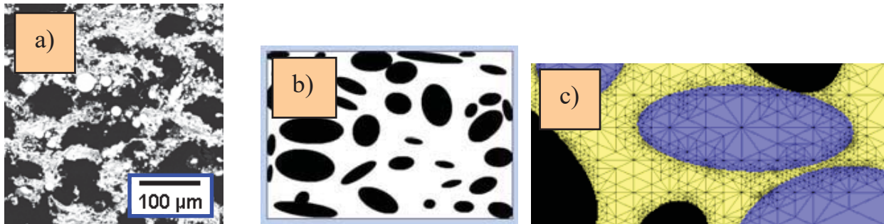
Figure 1. a) micrographie d'une section de revêtement abrasable (CoNiCrAlY - BN) – b) Ellipses équivalentes avec ImageJ – c) Maillage des ellipses avec OOF
