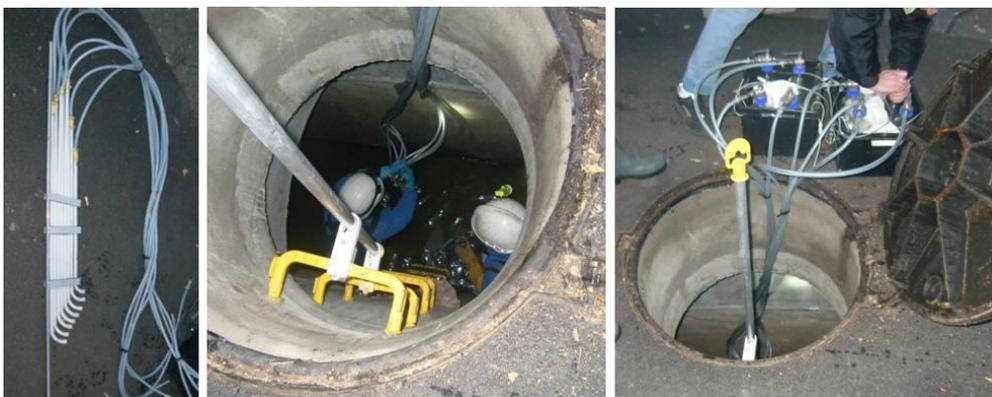
**Figure 5: Prélèvement d'eaux usées avec le préleveur multipoint vertical**
