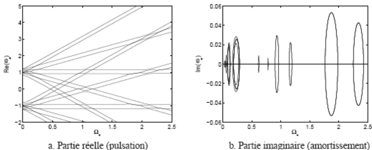
**Figure 3.** Evolution des valeurs propres du système en fonction de la vitesse de rotation
