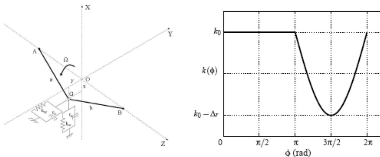
**Figure 1.** Rotor fissuré sur palier anisotrope et allure de la fonction raideur
