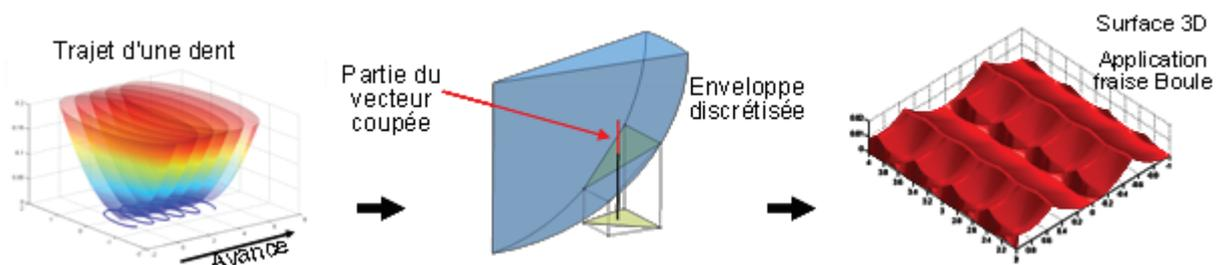
**Figure II.** Principe de modélisation de la surface
