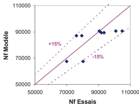
**Figure IV.** Comparaison Modèle/Essais sur éprouvettes flexion 4 points UGV
