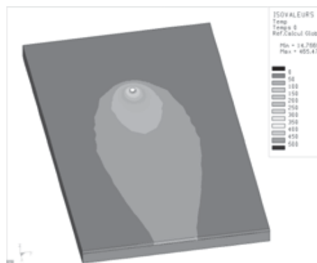
Figure 2. Champ des températures (°C) obtenu pour le soudage de 2 tôles en alliage d'aluminium de type 7075 (Feulvarch et al., in press).
