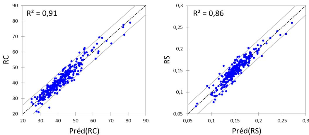
Fig. 2 : Exemples de modèles prédictifs pour la contrainte de rupture en compression  $RC = -21,1 - 0,2 * LC + 102,3 * D + 0,9 * MS$  et le retrait surfacique total.  $RS = -0,20 - 1,10 * 10^{-3} * LC + 0,11 * D + 6,45 * 10^{-2} * IR_{\alpha R} + 0,23 * IR_{\alpha T} + 0,67 * IR_{\alpha PSF} + 2,78 * 10^{-3} * D * MS$
