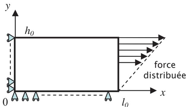
**Figure 2** *Modèle mécanique (configuration étudiée)*
