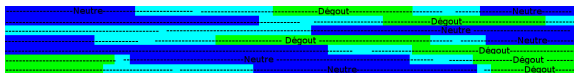
Figure 4: Segmentation automatique d'expressions isolées via un HMM à 3 états. On distingue ici en bleu l'expression neutre, en cyan un état intermédiaire et en vert les pics expressifs. Chaque ligne correspond à 6 secondes d'enregistrement, l'expression enregistrée est le dégoût répété 6 fois (textuellement en noir : l'annotation manuelle).
