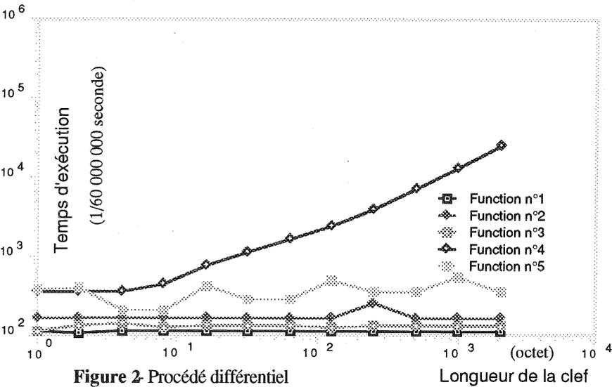
Remarquons que certaines fonctions (notamment la fonction n°1) propose un procédé de calcul différentiel multiple dont la durée d'exécution de l'algorithme est proche de celle de l'algorithme associé au procédé mono-différentiel. C'est cette fonction de hachage munie de ce procédé de calcul de la valeur de hachage que nous utiliserons par la suite.
