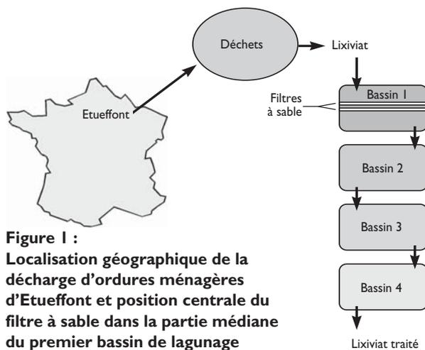
Figure 1 : Localisation géographique de la décharge d'ordures ménagères d'Etueffont et position centrale du filtre à sable dans la partie médiane du premier bassin de lagunage
