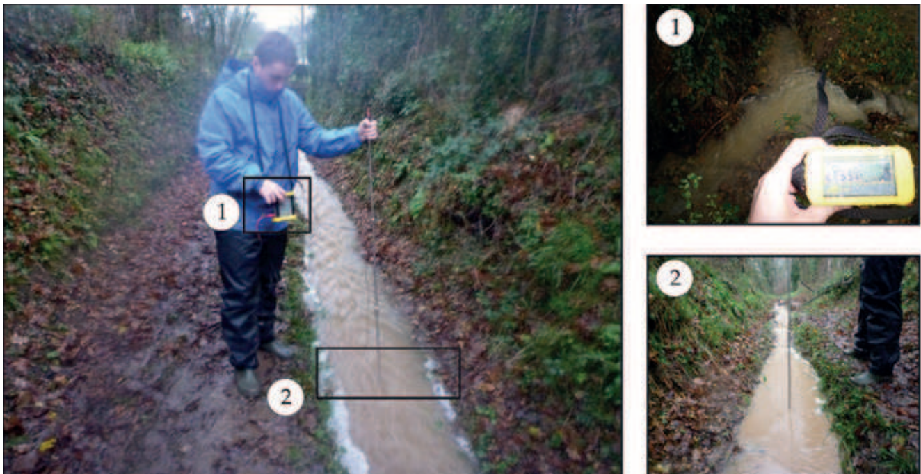
▲ Mesure des débits au moulinet.
