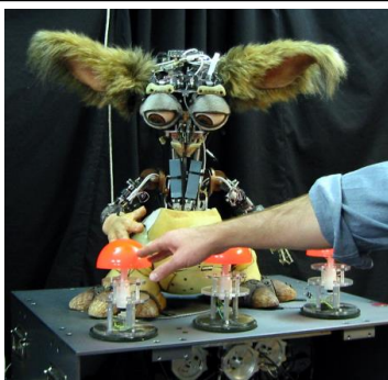
Fig. 3. Léonardo et son espace de travail. Léonardo est un robot humanoïde expressif possédant 65 degrés de liberté, conçu pour l'interaction sociale et le travail d'équipe (tiré de [33]).
