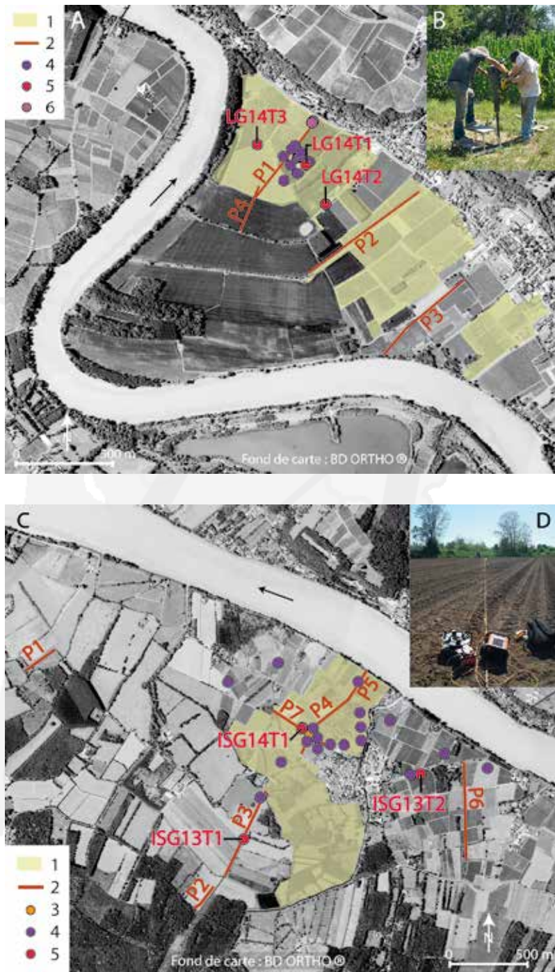
Fig. 6. Synthèse des interventions à Langoiran (A) et à Isle-Saint-Georges (C). © Lescure, 2014 ; B. Carottage avec un Cobra Mk1. © Lescure, 2014 ; D. Réalisation d'un profil de résistivité électrique. © Lescure, 2014. 1. Emprise des mesures de conductivité électrique apparente du sol, 2. Profil de résistivité électrique, 3. Coupe stratigraphique de 4,75 m de puissance, 4. Séquence verticale de 2 à 8 m d'épaisseur, 5. Séquence verticale de 8 à 10 m d'épaisseur, 6. Séquence verticale "complémentaire" de 9 m d'épaisseur.
