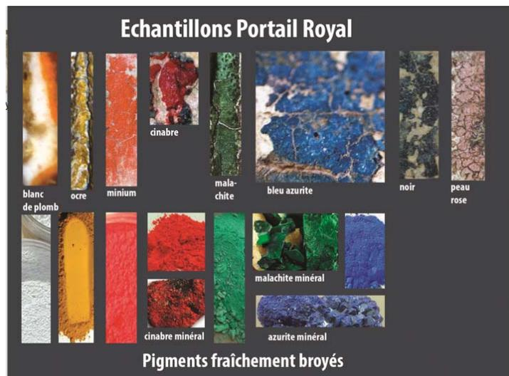
Fig. 16. Portail Royal, échantillons des différentes couleurs (en haut ; cl. M. Schlicht) et pigments correspondants, fraîchement broyés (en bas).
