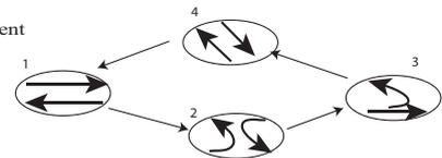
Figure 2: Exemples de diagrammes de phases d'une intersection
