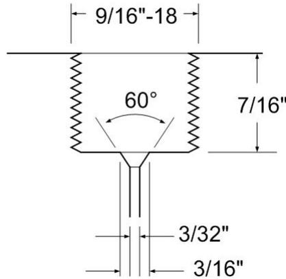
Figure 3 – Dimensions pour une connexion femelle 1/4" haute pression.
