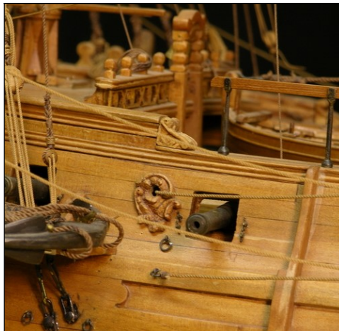
Figure 6 - Dogue d'amure d'une frégate XVIIIe siècle 9
