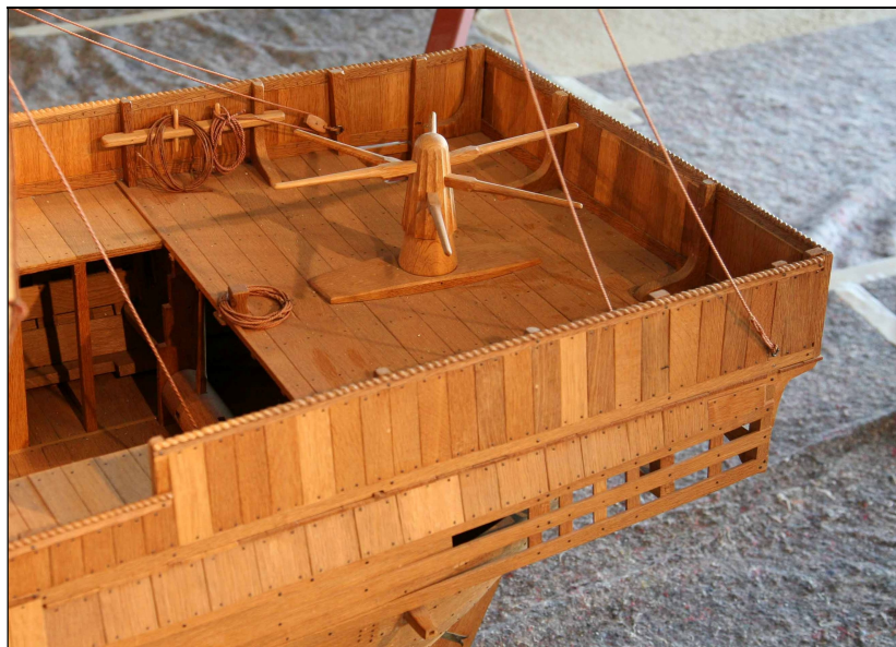
Figure 22 – Maquette de reconstitution de la cogue avec son cabestan 21 .
