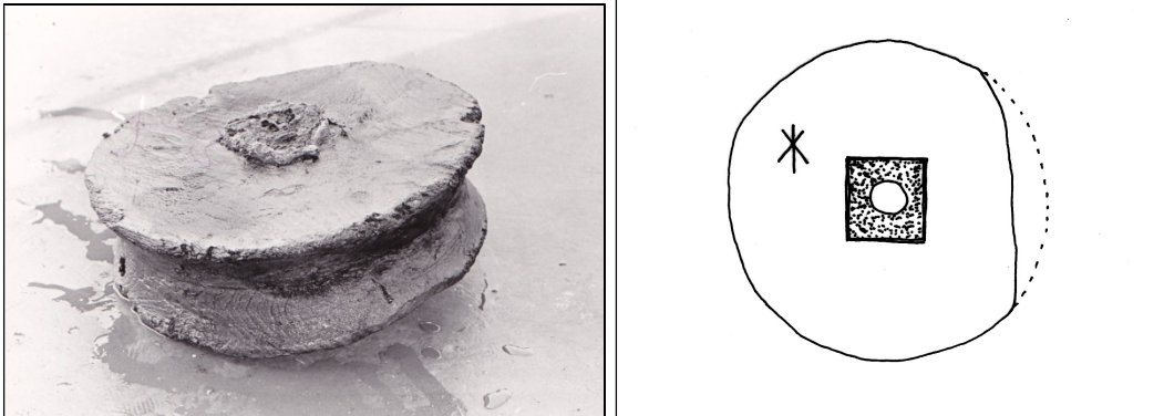
Figure 3 - Réa A 504 avec un dé central en bronze de 8 cm de côté et une marque gravée
