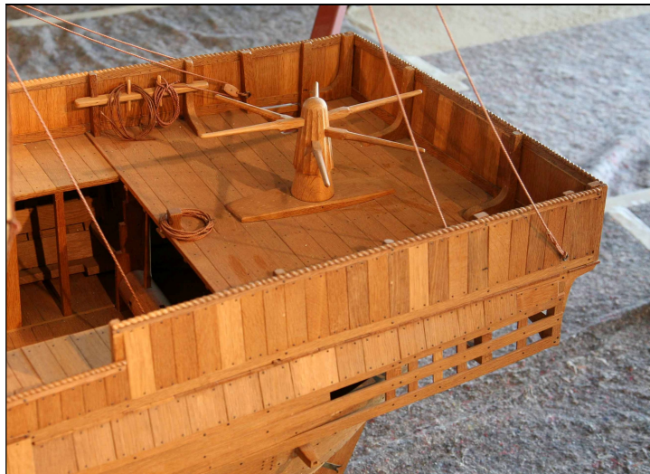
Figure 24 – Maquette de reconstitution de la cogue avec son cabestan 22 .
